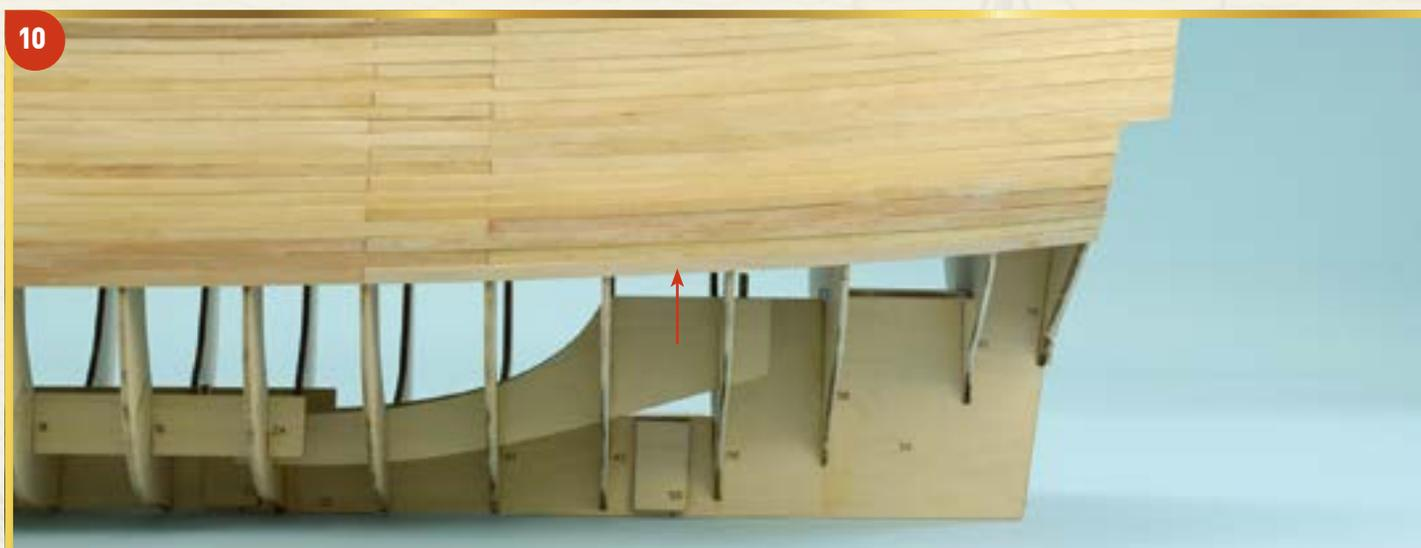
**10** Завершите текущий пояс обшивки, приклеив очередную планку к кормовой части каркаса.
