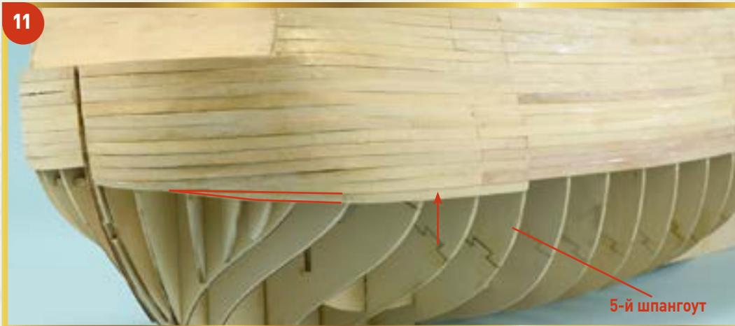
**11** Начните укладку следующего пояса обшивки, приклеив к носовой части каркаса новую планку, обрезанную и зауженную так, как показано на фотографии. Данная планка тоже не доходит до килевой рамки, а заканчивается чуть ранее.
