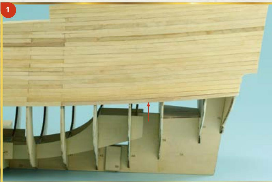
**1** Сегодня мы продолжим устанавливать черновую обшивку на нижней части корпуса нашей модели. Завершите нижний пояс обшивки на левом борту модели, приклеив планку к ее кормовой части.
